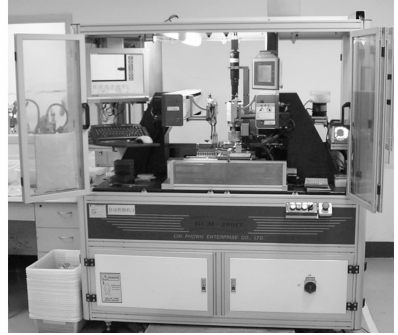
图 1 PCB 微钻头自动检测系统
